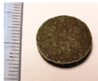
Получены композиционные алмазные материалы с рекордной теплопроводностью 6–9 Вт/смК, из которых изготовлены алмазные теплоотводы (на рис.)
