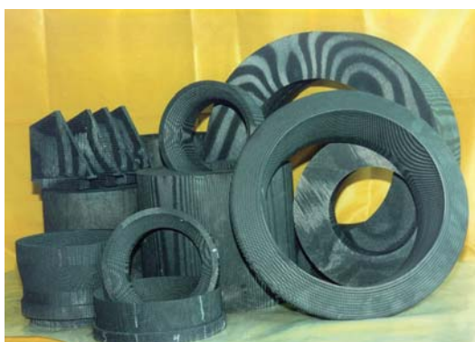
Детали для высокоэнергетических установок и транспорта, изготовленные из углерод-углеродного композита «Десна» на Большом прессе
