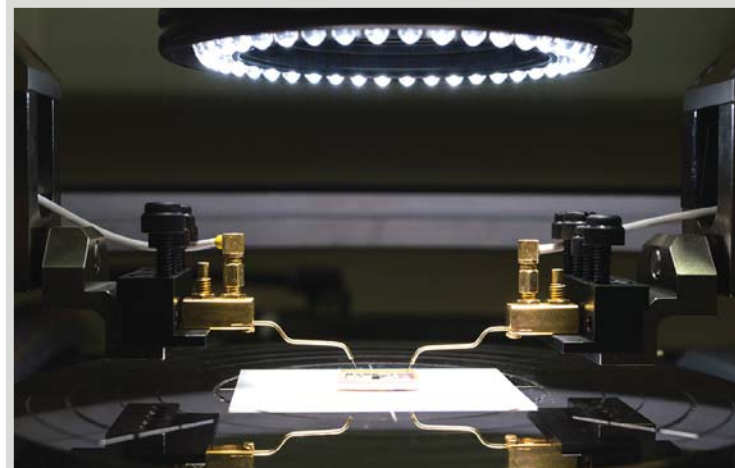
Электрические измерения на микроконтактах с помощью зондовой станции
