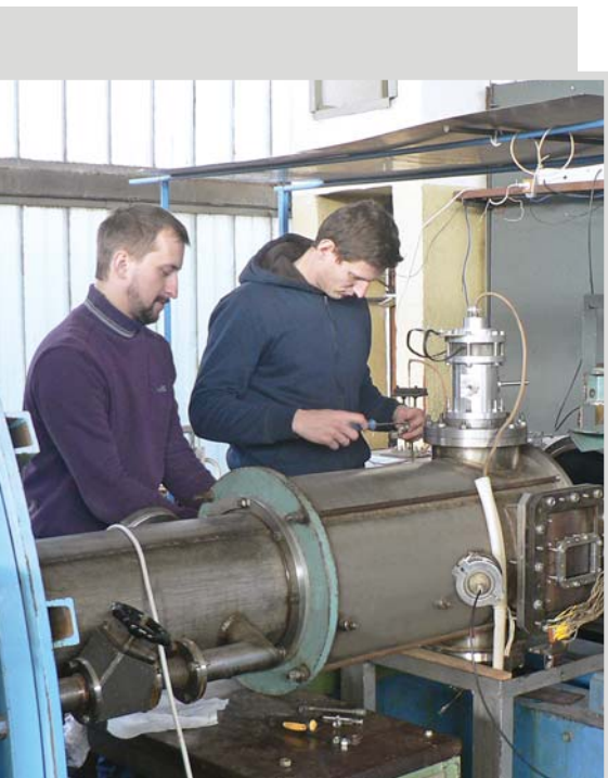
Эксперимент, проводимый на квазистационарном плазменном ускорителе КСПУ
